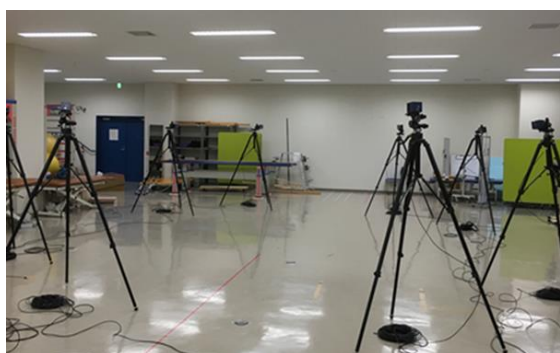
図2 光学式3次元動作解析システム 3D system Kestrel (Motion Analysis 社)設置方法 (7台)
