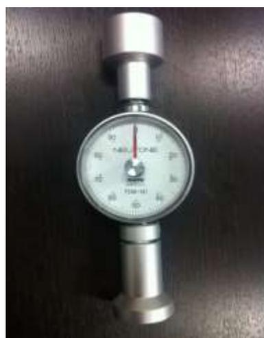
図2 筋硬度計: TRY-ALL 製デュロメーター
